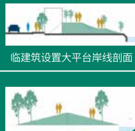
生态缓坡岸线剖面图
