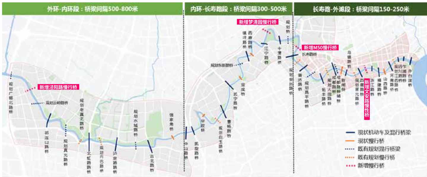
▲ 苏州河中心城段规划桥梁初步方案和建议桥梁密度
